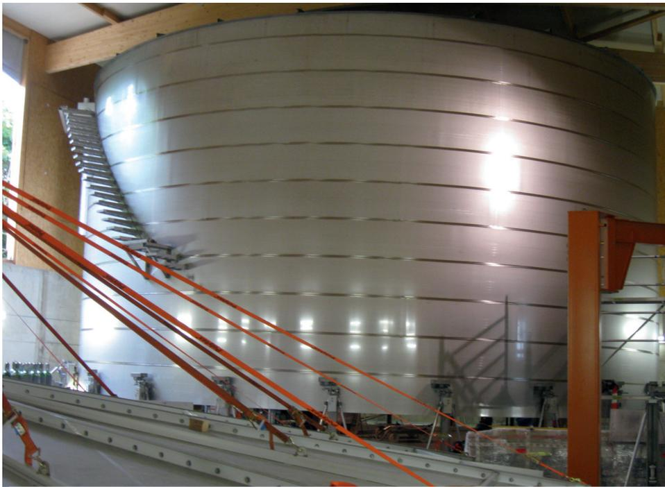
Fertigung der Trinkwasserspeicherbehälter aus Edelstahl V2A in Haar bei München
