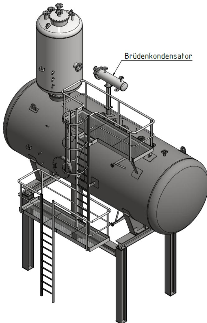
Thermische Entgasungsanlage mit Stahlunterbau und Brüdenkondensator (ohne Darstellung der Rohrleitungen)
