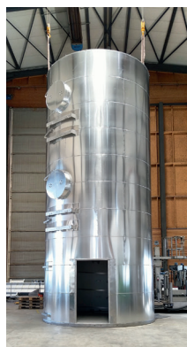
Tank mit Isolierung
