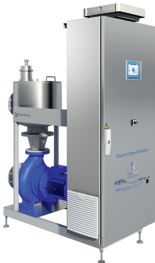
Die Einheiten beinhalten alle für den Betrieb erforderlichen Komponenten und werden anschlussfertig und geprüft ausgeliefert. Die Anlagen benötigen zum Betrieb technischen Sauerstoff (LOX) oder mittels PSA-Anlagen aufkonzentrierten Luftsauerstoff mit mind. 95 % O<sub>2</sub>-Konzentration.
