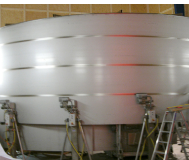
Abb. 8: Vollautomatisches Schweißen des Tanks (Außenansicht)
