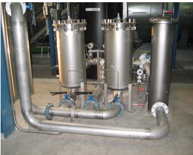
Vorfiltration über Kerzenfilter
