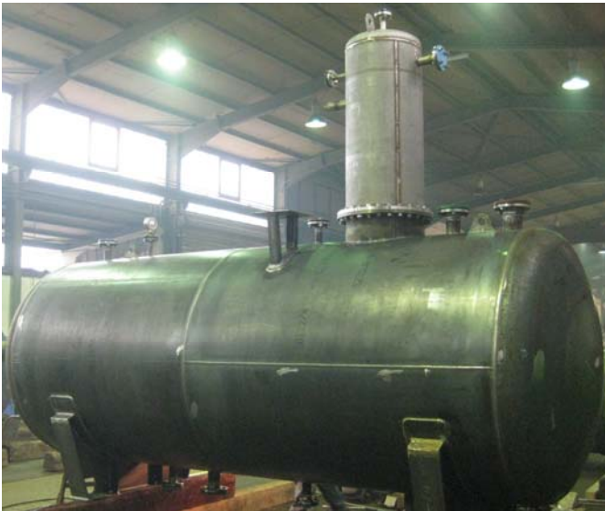
Entgasungsanlage in der Fertigungsphase
