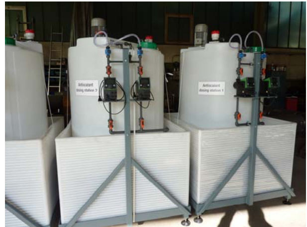
Dosierstation für Antiscalant
