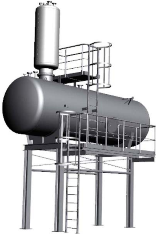
Entgasungsanlage in der Planungsphase
